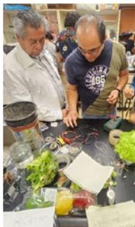
**2.** El circuito de alimentación eléctrica consta de una fuente de voltaje en corriente directa, una resistencia fija de 220 ohm, dos electrodos uno de cobre y otro de aluminio (sumergidos en el líquido extraído de cada verdura). Para la verificación de los valores se utilizó un multímetro digital.
