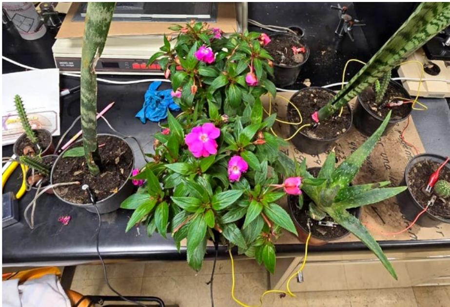
Después se conectaron en serie los electrodos elegidos, que fueron el alambre de cobre y el tornillo de zinc, haciendo combinaciones de pares y triadas entre especies de plantas; finalmente, se construyó una celda en serie, colocando hasta seis plantas como se muestra en la figura 3.
