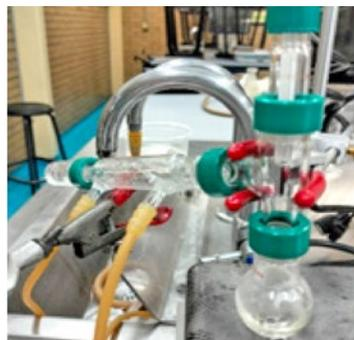
La segunda parte del experimento consistió en evaluar la cantidad de alcohol producido por cada uno de los sustratos. Para ello se filtró el producto de la fermentación y se realizó una destilación mediante un mini QuickFit, a una temperatura de 75 °C, para garantizar la obtención del etanol durante 3600 segundos (**Fig. 3**). El volumen de alcohol obtenido se midió con micropipeta de 0.001 ml.
