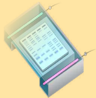
FIGURA 6. Cámara de electroforesis donde se aprecian las bandas de los segmentos de DNA. Tomada de https://www.genome.gov/es/genetics-glossary/Electroforesis
