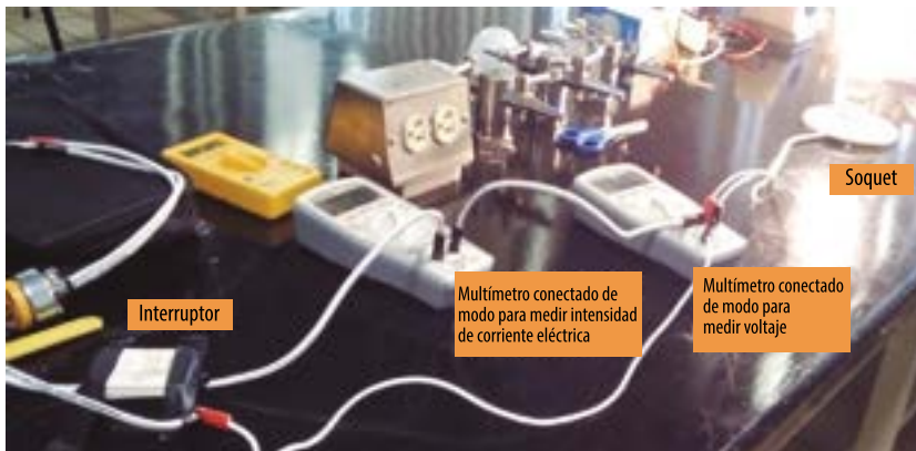
Figura 4. Circuito eléctrico conectando en paralelo el multímetro que mide el voltaje y en serie el multímetro que mide la intensidad de corriente
