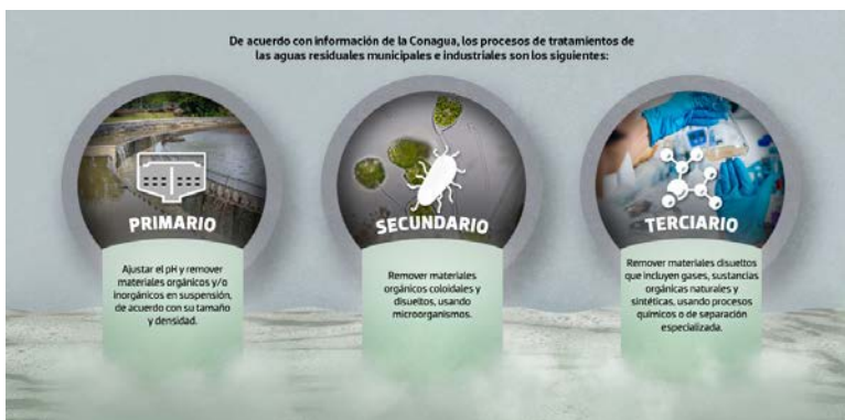
Imagen 4. Procesos de tratamiento en las plantas de aguas residuales (Durán y García, 2020).
