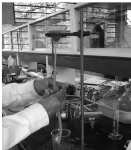
Imagen 5. Dispositivo para separar por decantación el aceite de la muestra de agua residual (Navarro y Montagut, 2008).
