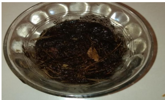
Imagen 21. El fenómeno de efervescencia y su intensidad es un indicador de la presencia de materia orgánica en el suelo.
