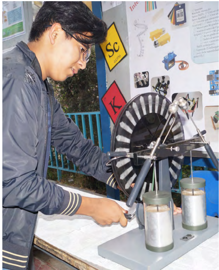
Una máquina de Wimshurst para generar descargas eléctricas.
