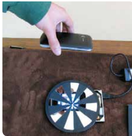
Imagen del objeto en los ocho espejospétalo parabólicos inmóviles.
