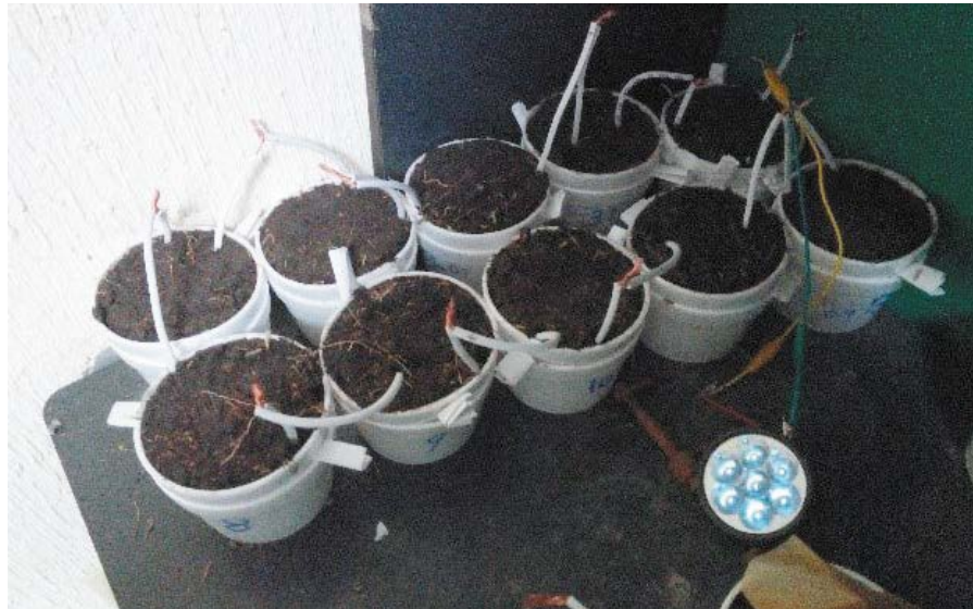
La imagen muestra un tipo de batería únicamente con tierra.
